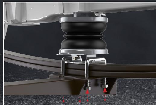
Die Muttern der Briegen werden mit passendem Drehmoment wieder angeschraubt
