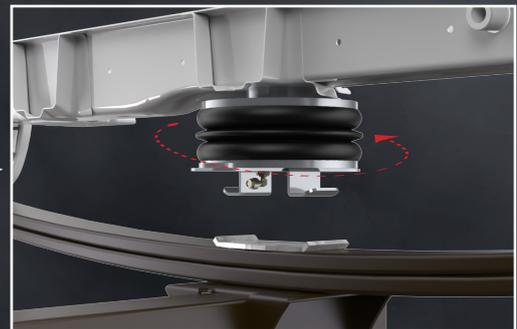
Der Luftbalg wird in das vorhandene Gewinde eingeschraubt
